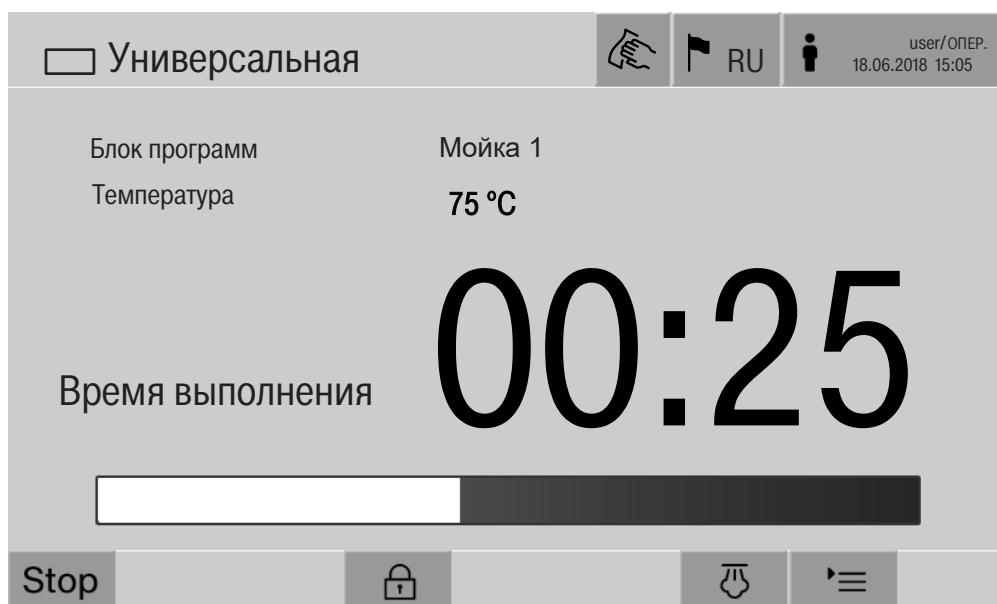
Кроме того, на дисплее отображается текущий блок программы и достигнутая температура.
